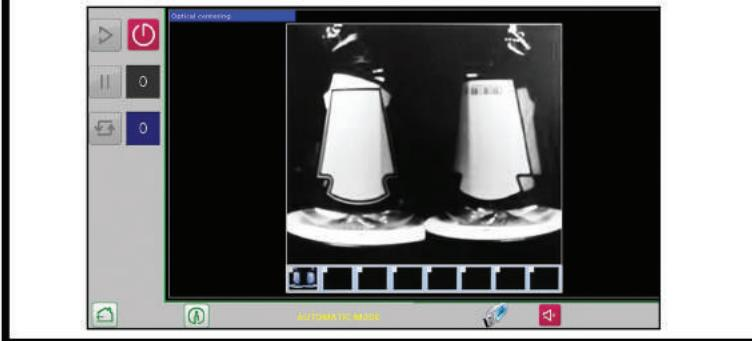
Telecamere fisse per il rilevamento di loghi di centraggio, saldature su vetro, capsule, codici a barre, controllo qualità, ecc...
